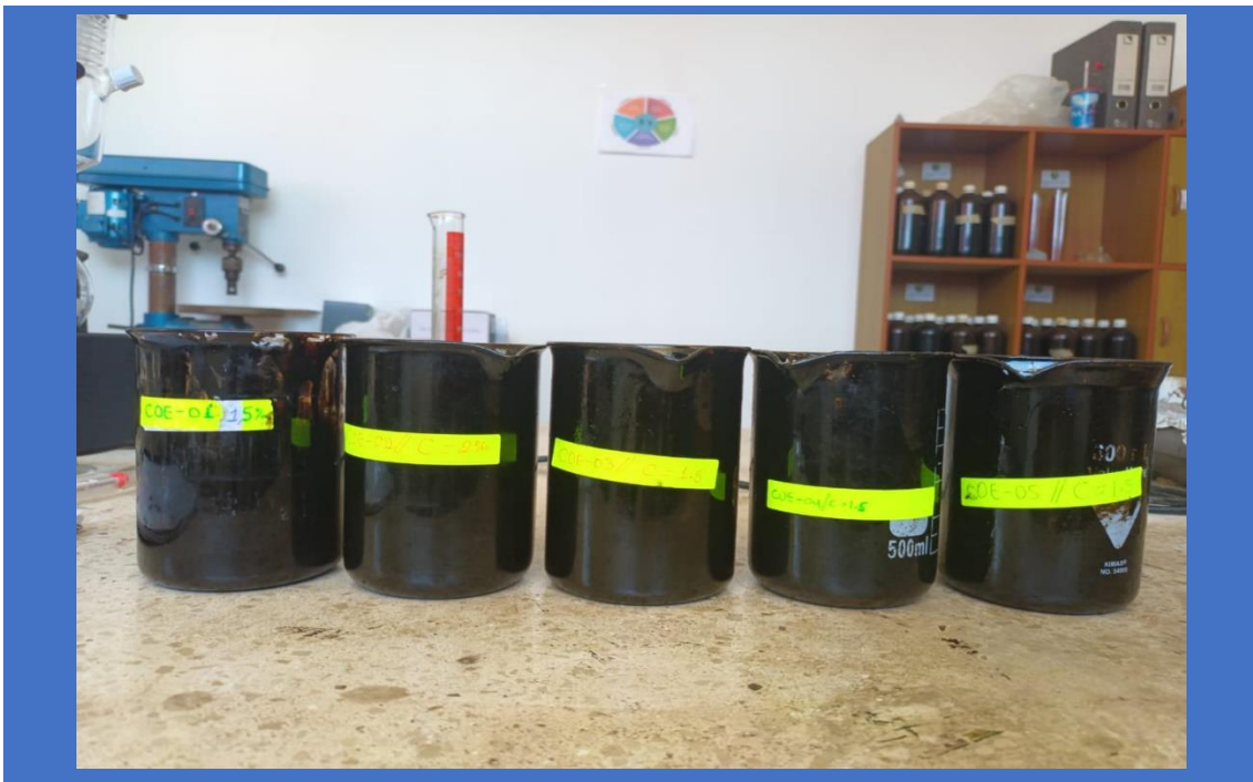
Figura B 2. Muestras del COE, aditivadas a diferentes concentraciones
