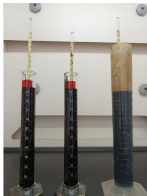
Figura 13. Método del hidrómetro en varias muestras de COE.
