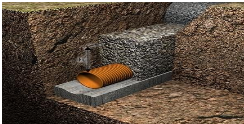
Zanja de drenaje
