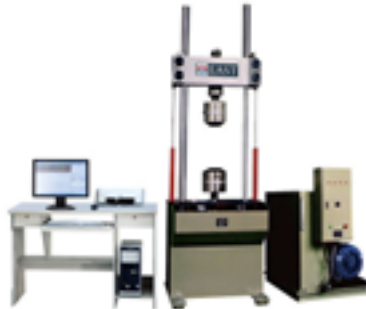
Figura 1.27: Máquina para el Ensayo de Fatiga. Fuente: Testersupply (2017)
