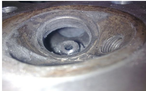
Figura 3.4: Defecto de agujero de gas. Fuente: Honda elite (2017).
