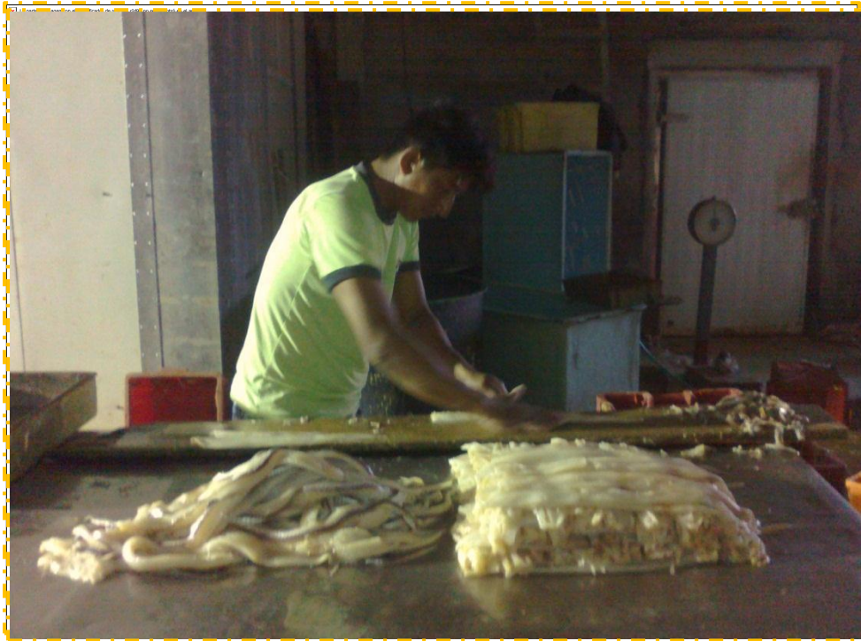
FOTO 4: PROCESO DE ENFUNDAR EL PESCADO PARA SER UBICADOS EN LATAS
