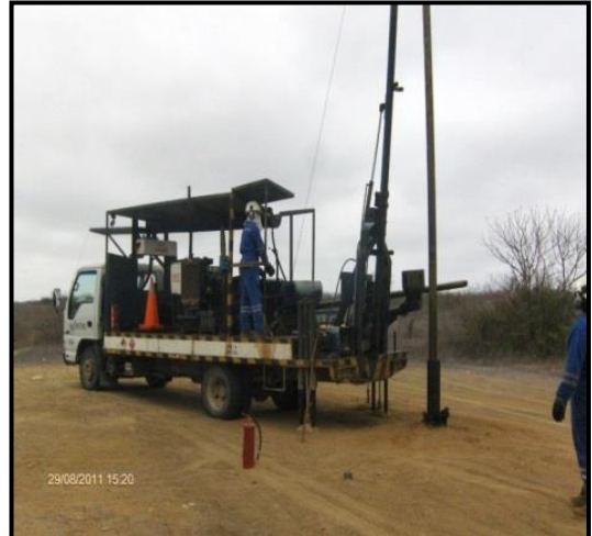
Figura 11: Cuchara y equipo móvil de la herramienta local
