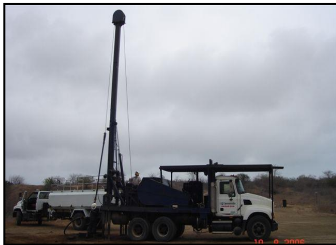
Figura 10: Camión de levantamiento artificial por pistoneo o Swab.
