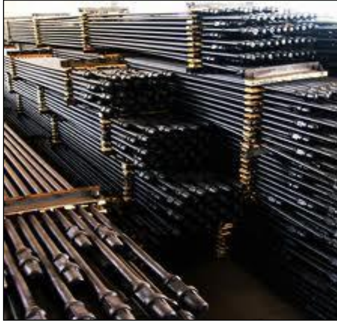
Figura 9: Varillas \frac{3}{4} " y \frac{5}{8} " del campo Ancón
