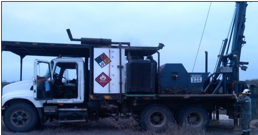
Figura 13: Equipo utilizado para el levantamiento artificial
