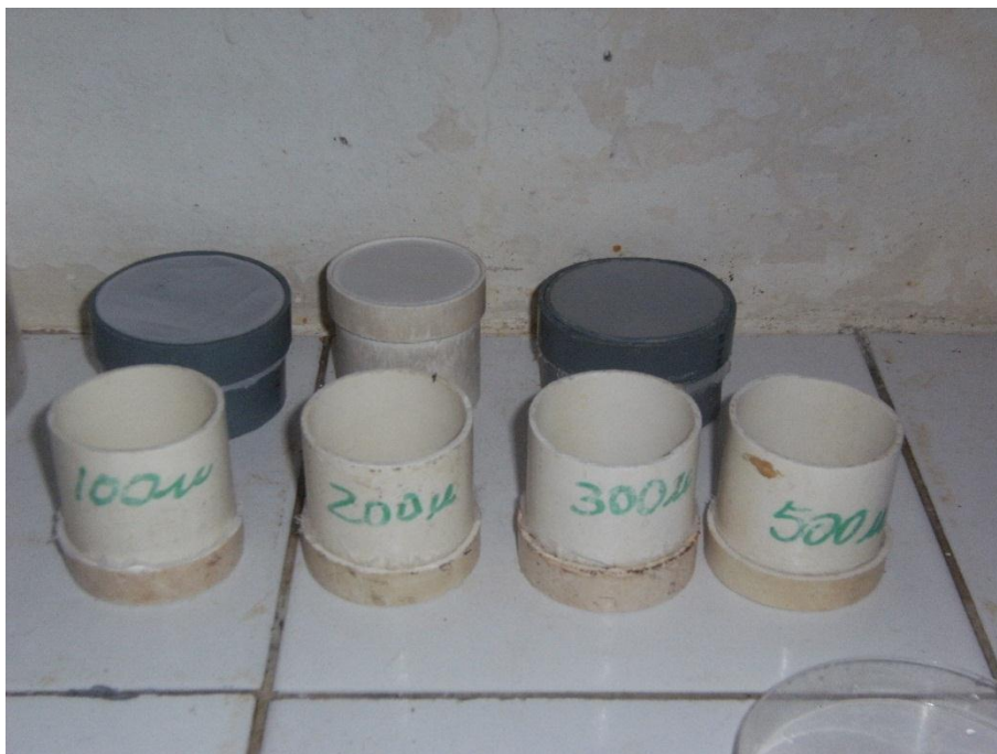
Imagen 7. Tamices de diferentes micrajes ( \mu ) usados en el trabajo de laboratorio.
