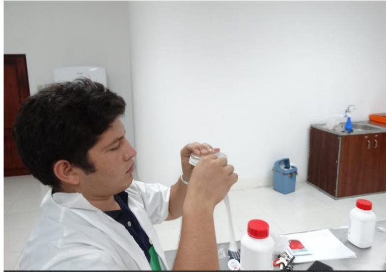
Figura 11 A. Sellado de las cajas con cinta aislante blanca.
