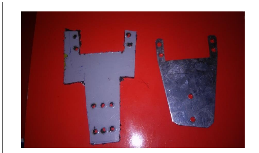
Figura 61: Pieza para ajustar la pinza sobre el cuerpo del robot
