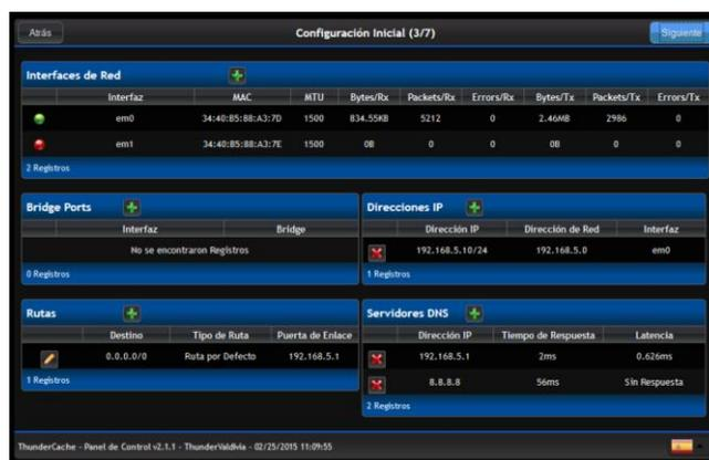
**Figura 5.35:** Configuraciones de tarjeta de red
