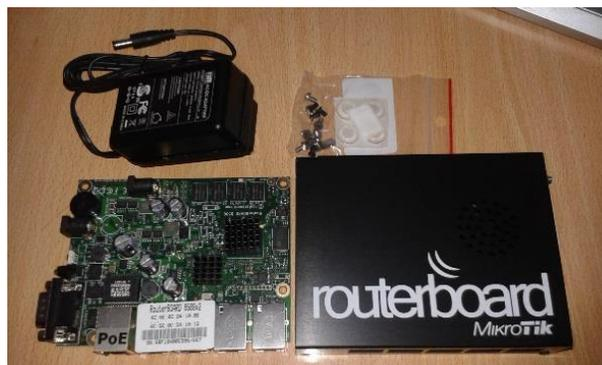
**Figura:** Partes y piezas del Router Mikrotik RB850Gx2
