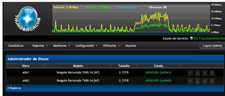
**Figura 5.46:** Discos montados en el sistema
