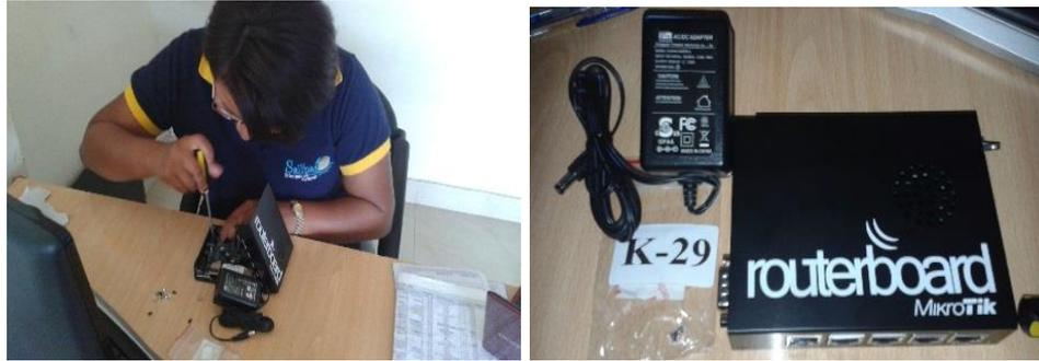
**Figura:** Armado del Router Mikrotik RB850Gx2
