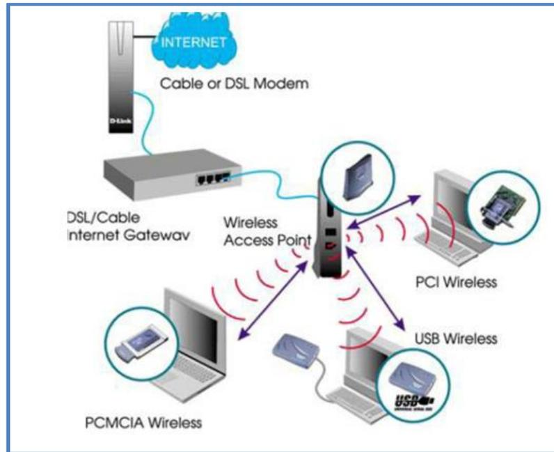
**Figura 2.2: Red de área local inalámbrica (WLAN)**
