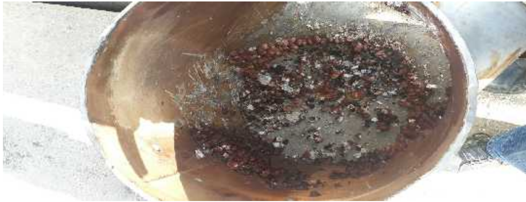
Figura 23. Corte de tubería dúplex, con materia orgánica adherida. trabajadores del Consorcio GLP Ecuador 39
