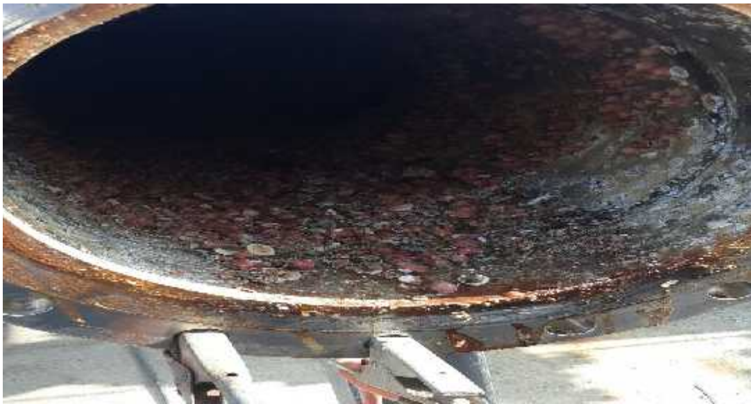
Figura 24. Corte de tubería dúplex, con materia orgánica adherida. trabajadores del Consorcio GLP Ecuador 40
