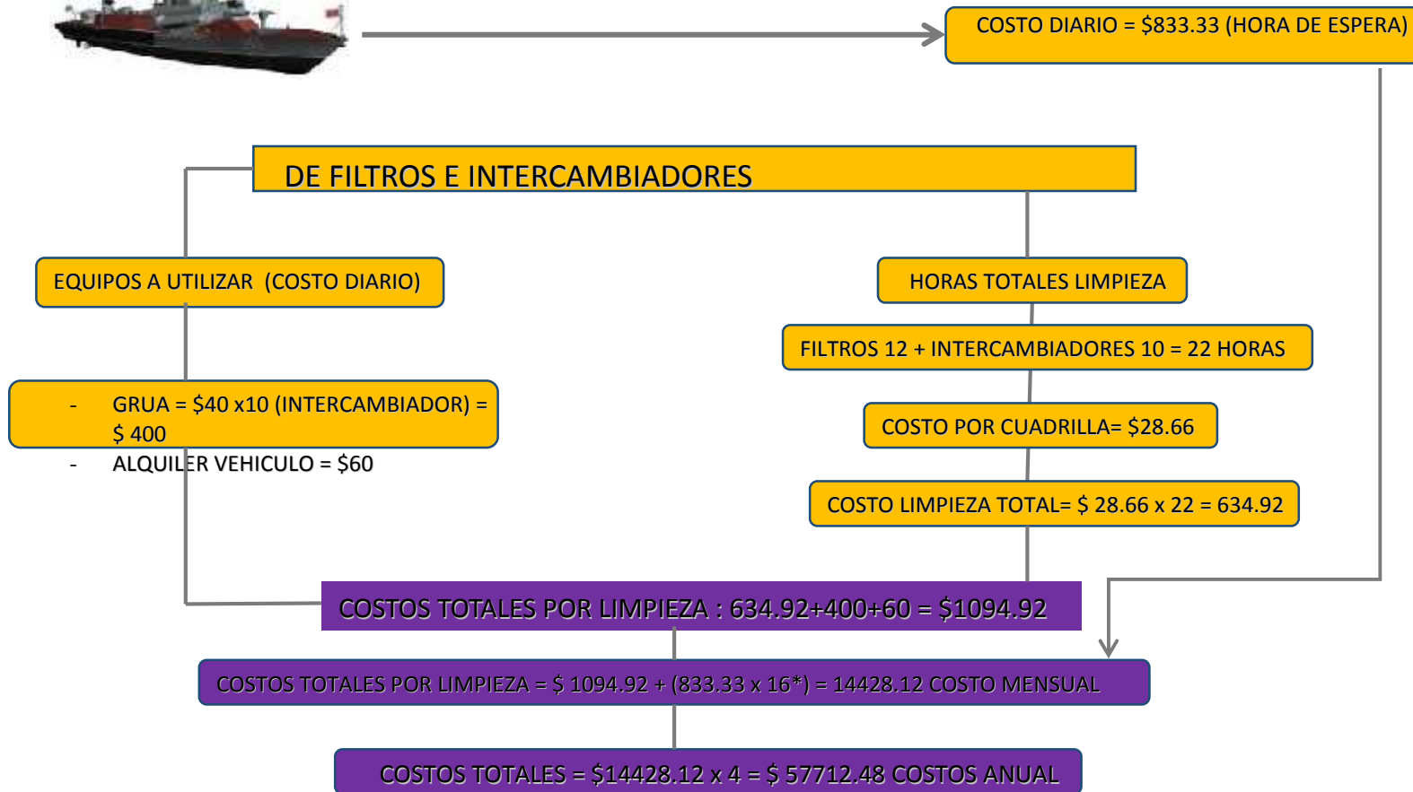
Figura 28 Costos de Limpieza de Taponamiento de filtros e intercambiadores Elaborado por: Santiago Abel Silva Tomalá 44
