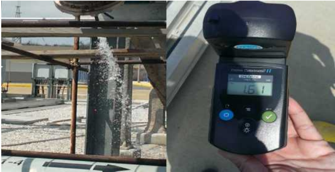
Figura 11. Resultado del análisis en la entrada al sistema (fondo filtro de planta de filtros) (aguas arriba). Fuente: Tomada en campo por Santiago Abel Silva Tomalá 22
