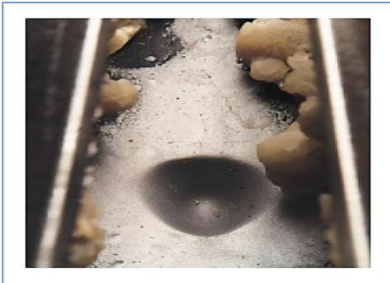
FIG. N° 2. 7 ELIMINACIÓN DE INCRUSTACIONES DE CARBONATO DE CALCIO CON CHORRO DE AGUA ABRASIVO;
