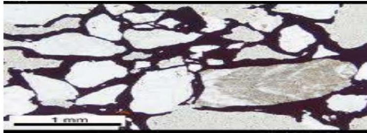
Figura 3.3 Lamina de la porosidad de una roca sedimentaria Fuente: www.scribd.com, 2015
