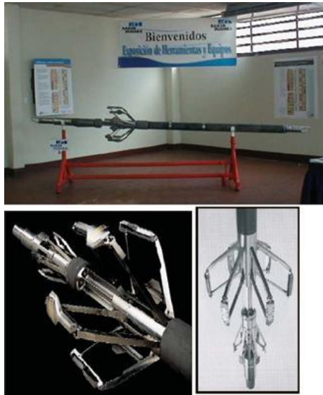
Figura 2.5 Herramienta utilizada para realizar la medición del SP
