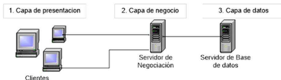
**Figura 11** Aplicación cliente servidor multinivel de tres capas
