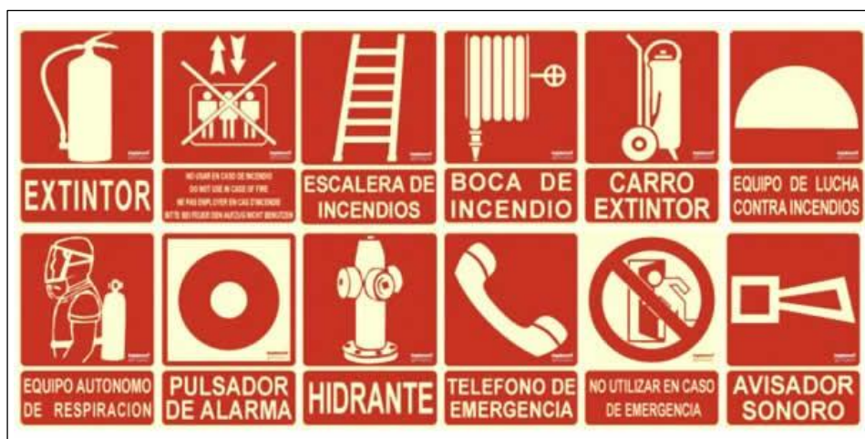
Figura 21 Señalética Contra Incendios
