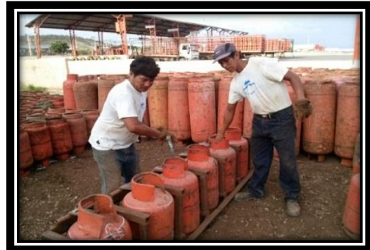
Imagen N° 9 Extracción de válvulas
