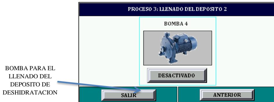
Figura 37: Pantalla HMI para el llenado del depósito de deshidratación.
