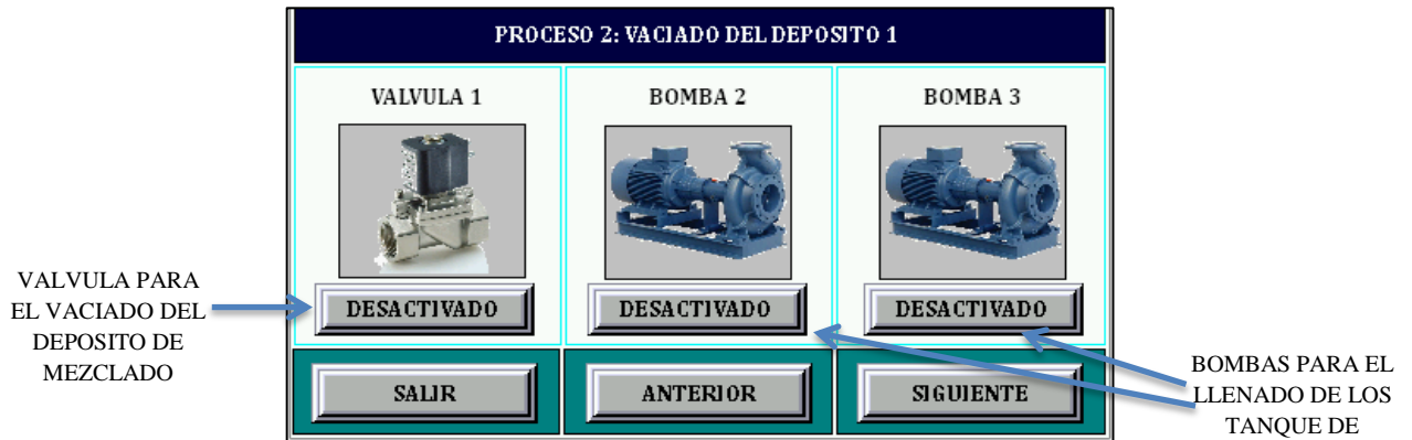
Figura 35: Pantalla HMI de los elementos del proceso de vaciado del depós mezclado.
