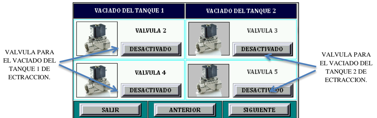
Figura 36: Pantalla HMI de los elementos del proceso de vaciado del depósito de extracción.
