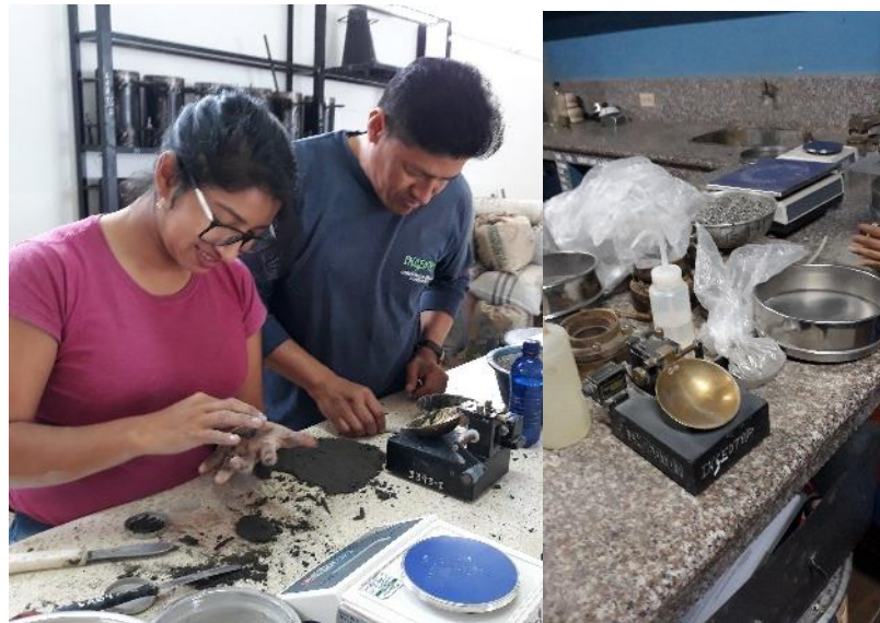
Figura 8. Amasado de muestras para límites de Atterberg.
