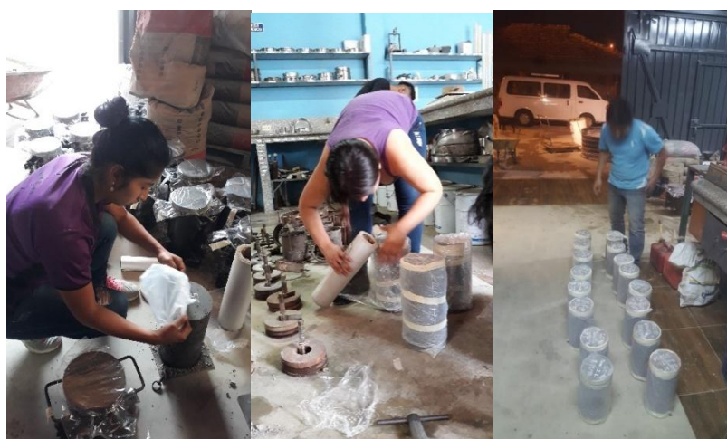
Figura 20. Curado de probetas de suelo – cemento.
