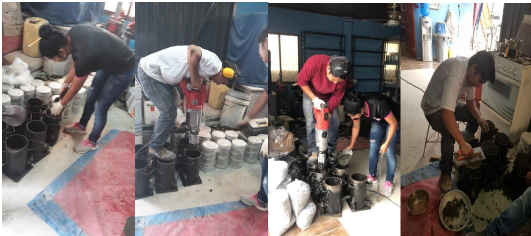
Figura 19. Mezcla manual de materiales para elaboración de probetas.
