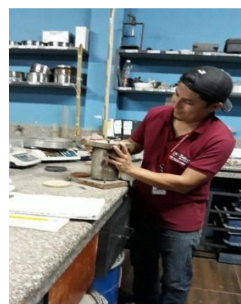
Figura 11. Ensayo de Permeabilidad.
