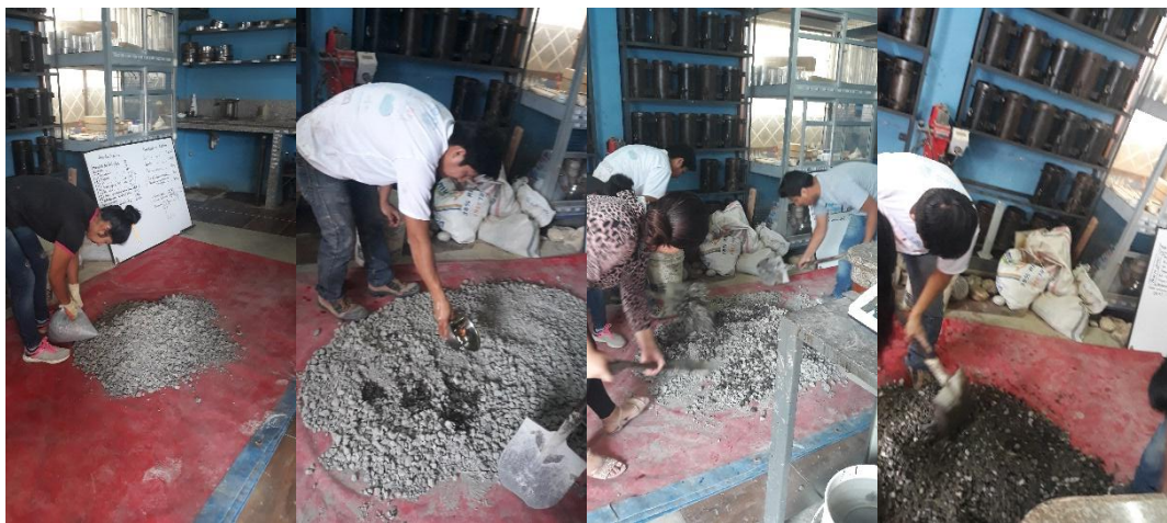
Figura 18. Mezcla manual de materiales para elaboración de probetas.
