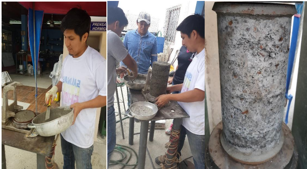
Figura 21. Refrentado a probetas (caping).
