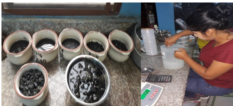
Figura 15. Ensayo de sulfatos.
