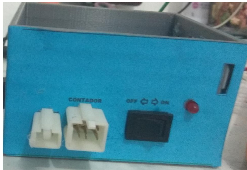
Ilustración 55 Switch de ON/OFF y conectores del módulo de contador e indicador de estado de puerta.
