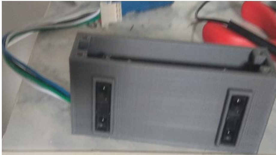
Ilustración 65 Ubicación de los sensores de distancias
