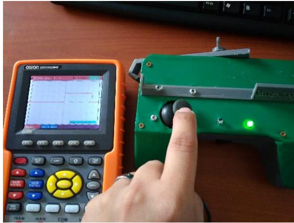
Figura 89 Servomotor direccional a 180°
