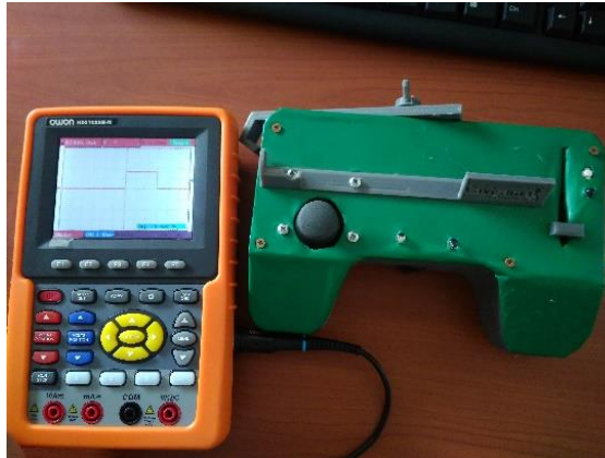
Figura 91 Servomotor inmersión a 90°
