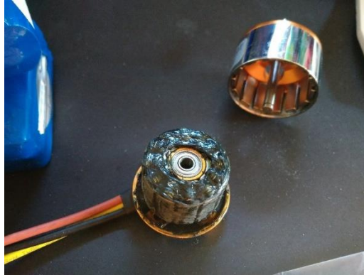
Figura 73 Motor Brushless A2212 recubierto con Pegatanque
