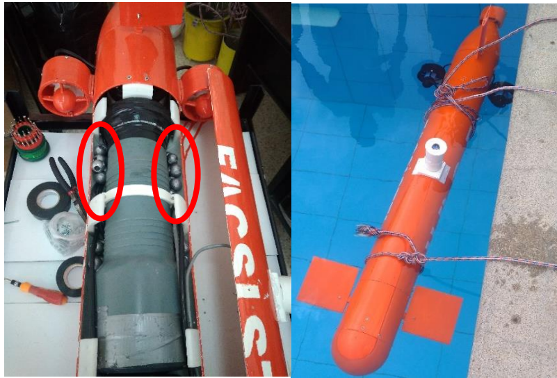
Figura 93 Robot Submarino Boyanza Neutral En Piscina UPSE
