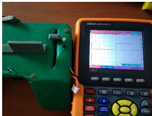
Figura 86 Motores a velocidad completa
