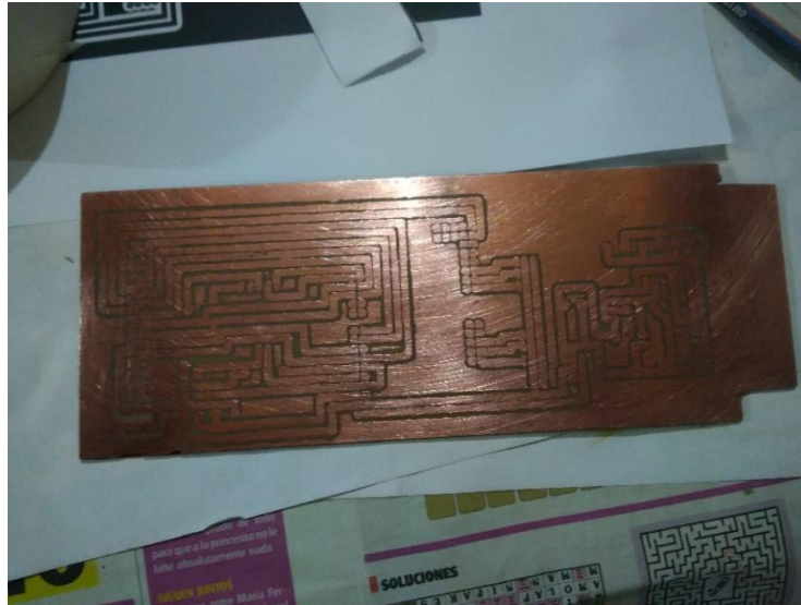
Figura 41 Baquelita Limpia Luego de Pasarla por Cloruro Férrico
