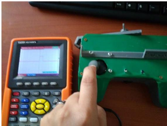
Figura 87 Servomotor direccional a 0°
