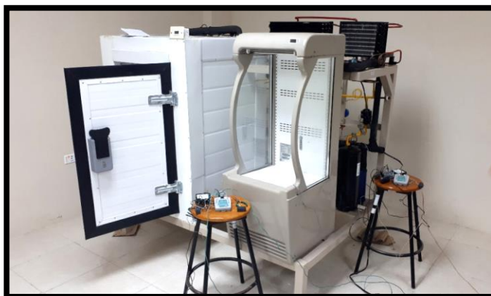
figura 2. Planta prototipo de refrigeración
