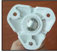
Figura 57. Soporte de sensor de movimiento. Tomada por Joselyn Torres.
