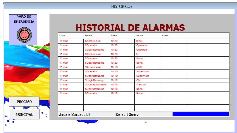
Figura 60 Pantalla de historial de alarmas. Elaborado por el autor
