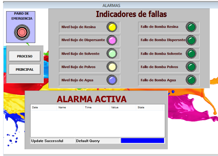
Figura 59 Pantalla de alarmas activas. Elaborado por el autor
