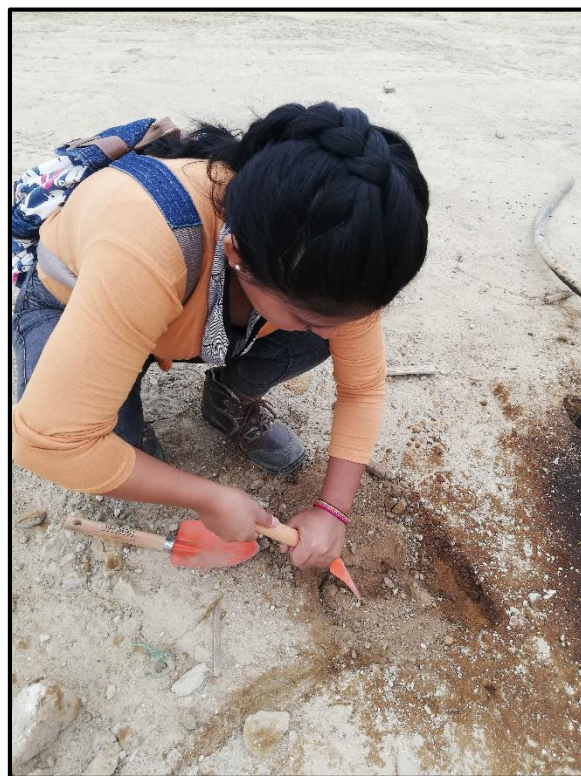
Figura 57. Toma de muestra del suelo contaminado (Pozo SPA CH 1).
