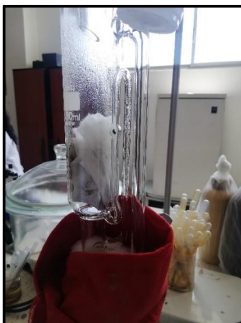
Figura 38. Evaporación del cloroformo en el extractor. Elaborada por: Karen Yagual – Laboratorio de petróleo UPSE, 2020.
