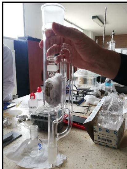
Figura 35. Tubo extractor con la muestra de suelo. Elaborada por: Karen Yagual – Laboratorio de petróleo UPSE, 2020.
