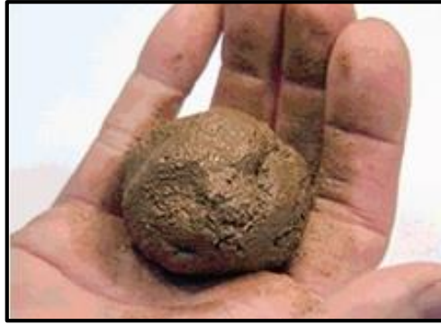
Figura 26. Formar una bola de 2,5 cm de diámetro de la muestra de suelo. Elaborada por: Karen Yagual – Laboratorio de suelo UPSE, 2020.
