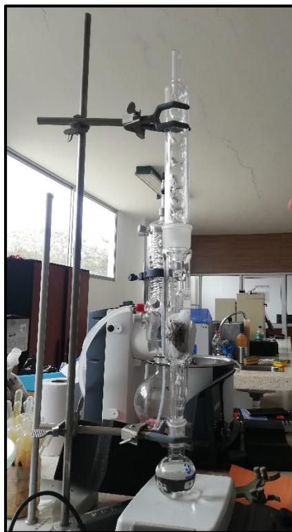
Figura 36. Montaje del equipo soxhlet.
