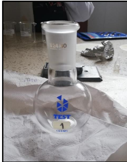
Figura 33. Balón de fondo plano de 100 ml de boca esmerilada 24/40. Elaborada por: Karen Yagual – Laboratorio de petróleo UPSE, 2020.
