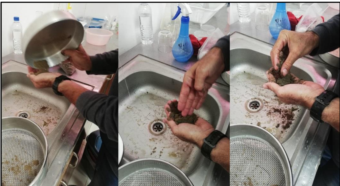
Figura 25. Humedecer la muestra de suelo Pozo VA 10. Elaborada por: Karen Yagual – Laboratorio de suelo UPSE, 2020.
