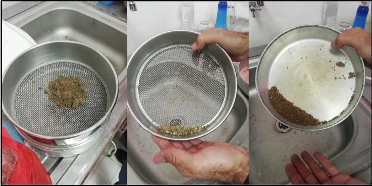
Figura 24. Proceso de tamizado de la muestra de suelo Pozo VA 10. Elaborada por: Karen Yagual – Laboratorio de suelo UPSE, 2020.
