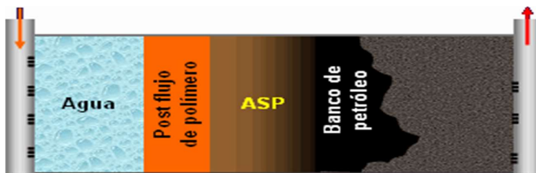
Figura 49. Etapas de la inyección ASP
