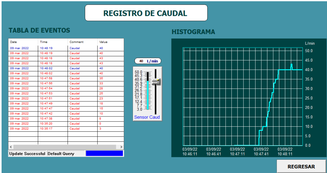
Figura 122. Registro de eventos del sensor de caudal analógico.
