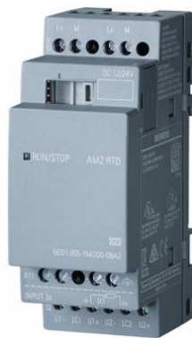
Figura 11. Módulo de Ampliación AM2 RTD [35].
