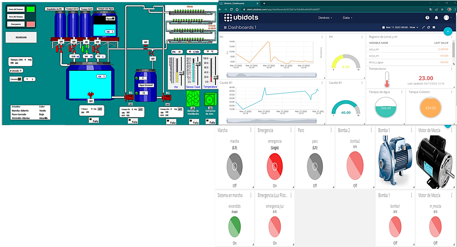
Anexo 6: Verificación de envío y recepción de datos desde SCADA hacia Ubidots.
