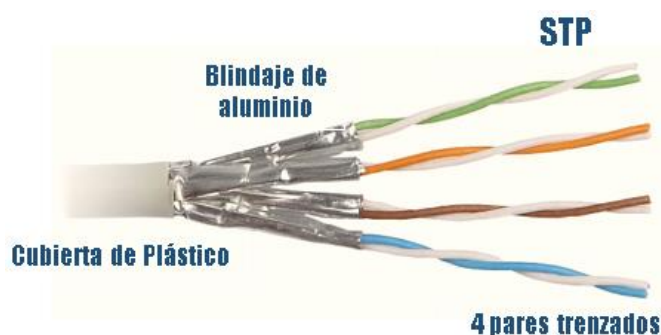
Figura 2.6. Cable de Par Trenzado 4 hilos con blindaje individual.
