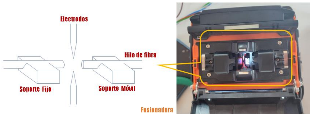
Figura 2.23. Empalme por Fusión.
