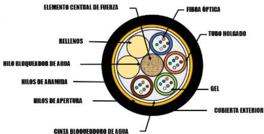
Figura 4.8. Estructura de cable ADSS de 16 núcleos
