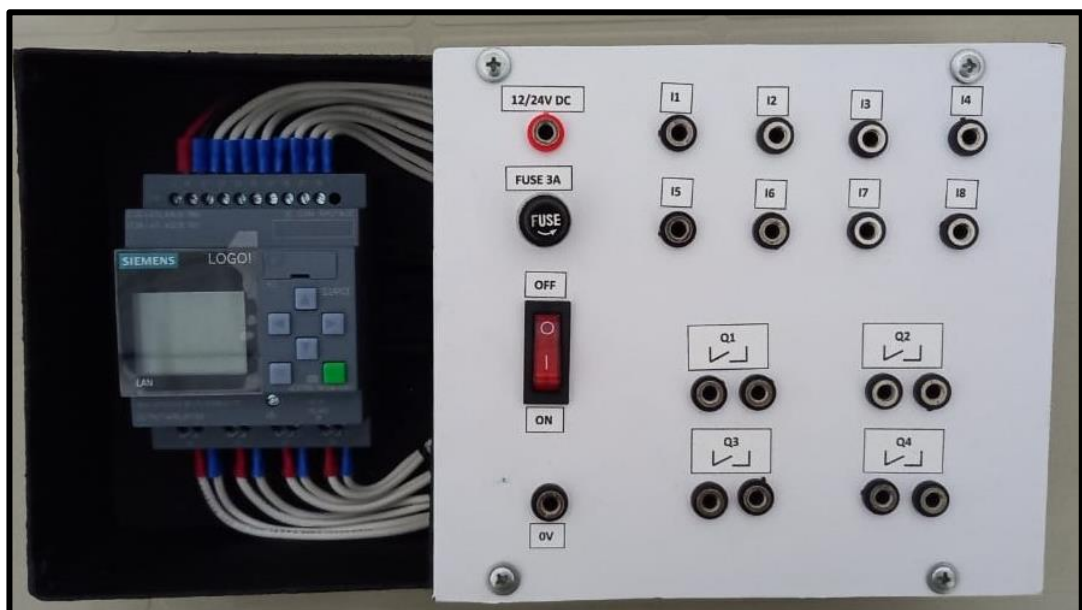
Figura 1.4 Diseño final del módulo PLC-LOGO!
