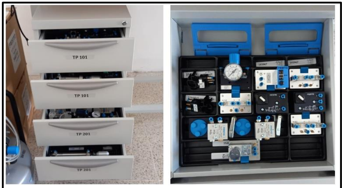
Figura 1.2 Identificación y señalización de componentes neumáticos y electro neumáticos.
