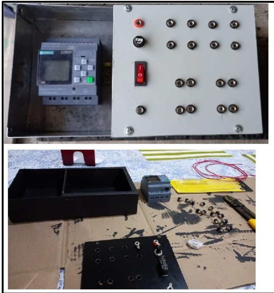
Figura 1.3 Construcción del módulo PLC-LOGO!
