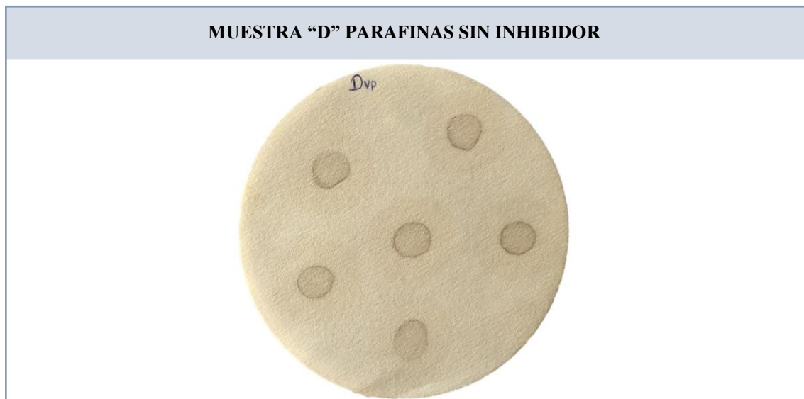
Figura B 8. Método de la mancha para la determinación de parafinas sin inhibidor de la muestra "D".
