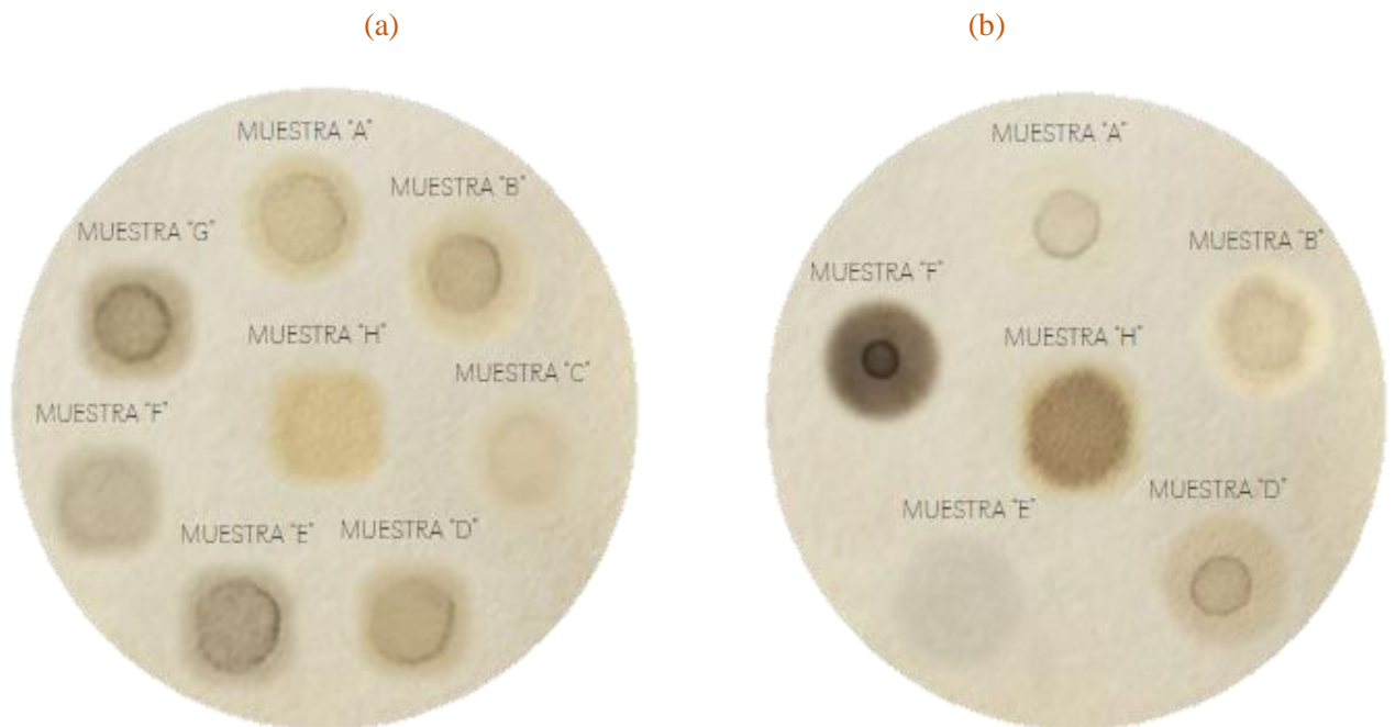
Figura 21. Prueba de la mancha de parafinas (a) y asfáltenos (b) sin inhibidor.
