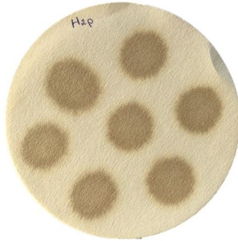
Figura B 17. Método de la mancha para la determinación de parafinas sin inhibidor de la muestra "H".
