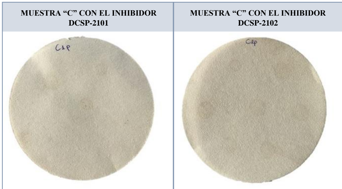
Figura B 6. Método de la mancha para la determinación de parafinas con inhibidor de la muestra "C".
