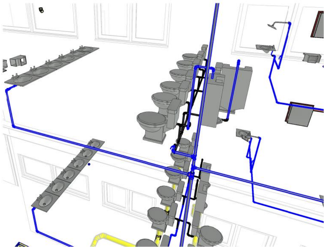
Figura 26. Instalaciones de tuberías de agua potable.
