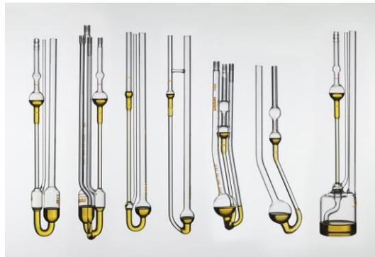
Ilustración 1 Viscosímetros capilares de vidrio o Ostwald
