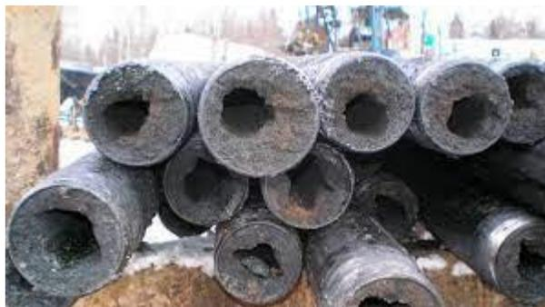
*Ilustración 5: Tubería que ha sufrido un proceso de precipitación y deposición de parafina y asfaltenos
