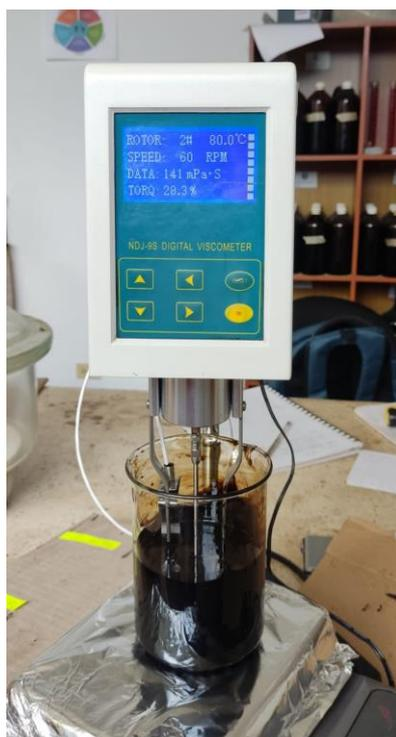
*Ilustración 12 Uso del Viscosímetro rotacional*
