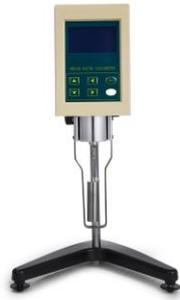
*Ilustración 2 Viscosímetro rotacional*
