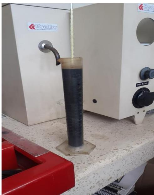
*Ilustración 8 Toma de gravedad API usando Hidrómetro*
