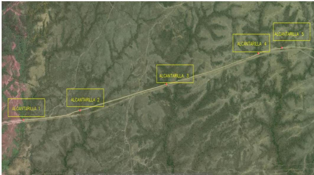
Gracias a el estudio topográfico se evaluó la hidrografía del terreno, en el que se observó que la vía posee afluentes, quebradas y cauces, por el cual se debe hacer un estudio hidrológico a profundidad, para realizar el diseño de alcantarilla en función a las características de la cuenca hidrográfica y de la vía en la que se realizara el diseño.
