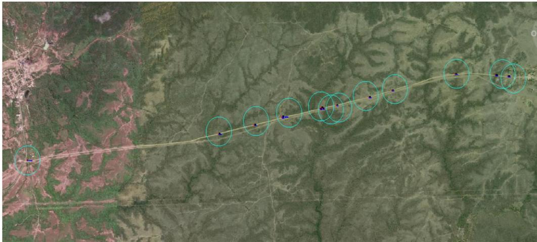
Una vez finalizado el levantamiento, el trabajo de gabinete consistió en la extracción de la información almacenada en la estación total hacia el ordenador, en donde se obtuvo como resultado el registro de los 1324 puntos topográficos de la vía desde el inicio hasta aproximarse a la comuna Sayá, como se puede observar en la tabla de todos los puntos en el **Anexo 12**.
