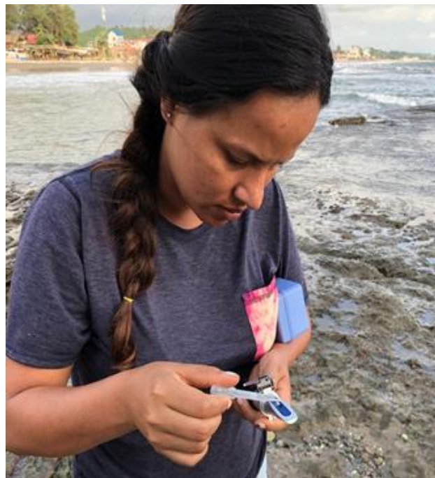
Figura 16. Registrando datos del parámetro de salinidad con el uso de salinómetros.
