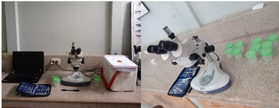
Figura 7. Estereomicroscopio de 10x WF con aumento de 2x, 4x, equipo de disección, caja Petri y frascos de muestras. Fuente: Hilaño, 2023.
