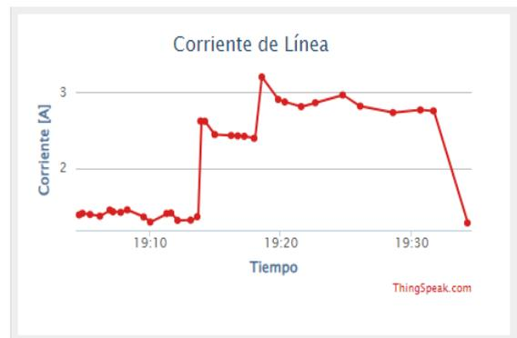
a). Gráficas del comportamiento de la corriente y potencia en el tablero de distribución.
