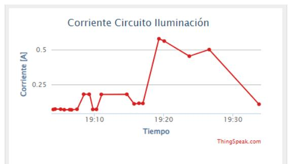
b). Gráficas del comportamiento de la corriente y potencia del circuito de iluminación.
