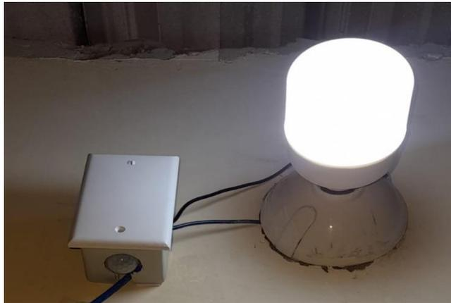
b) Módulo relé y sensor PIR para el control de la luminaria del cuarto de baño.
