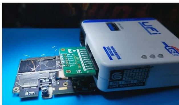
Imagen 28: Conexión de placa base al adaptador y caja box.
