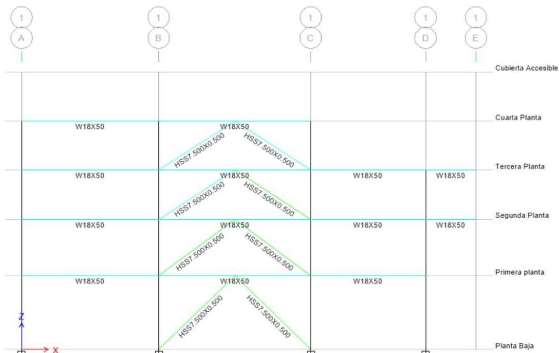
De acuerdo al análisis estructural realizado en ETABS, se logra obtener un ratio de demanda - capacidad de 0.627, configuración analizada nuevamente con el perfil circular HSS7.500X0.500. En la siguiente tabla se logra apreciar un resumen de los perfiles HSS que obtuvieron como resultado del proceso de análisis en ETABS para el sistema de arriostramiento lateral seleccionado.
