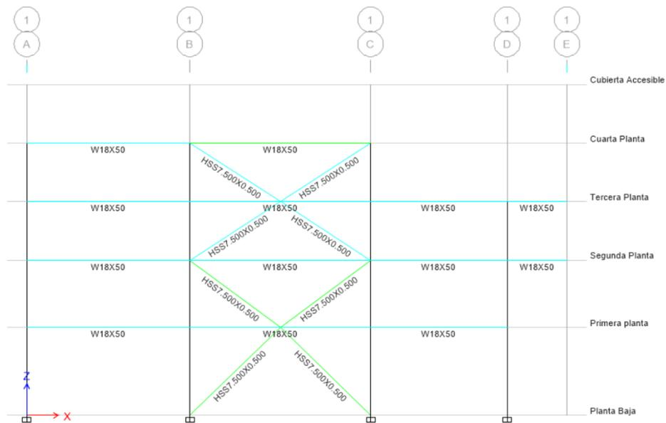
Se obtiene un ratio de demanda - capacidad de 0.624, configuración analizada con el mismo perfil circular HSS7.500X0.500.
