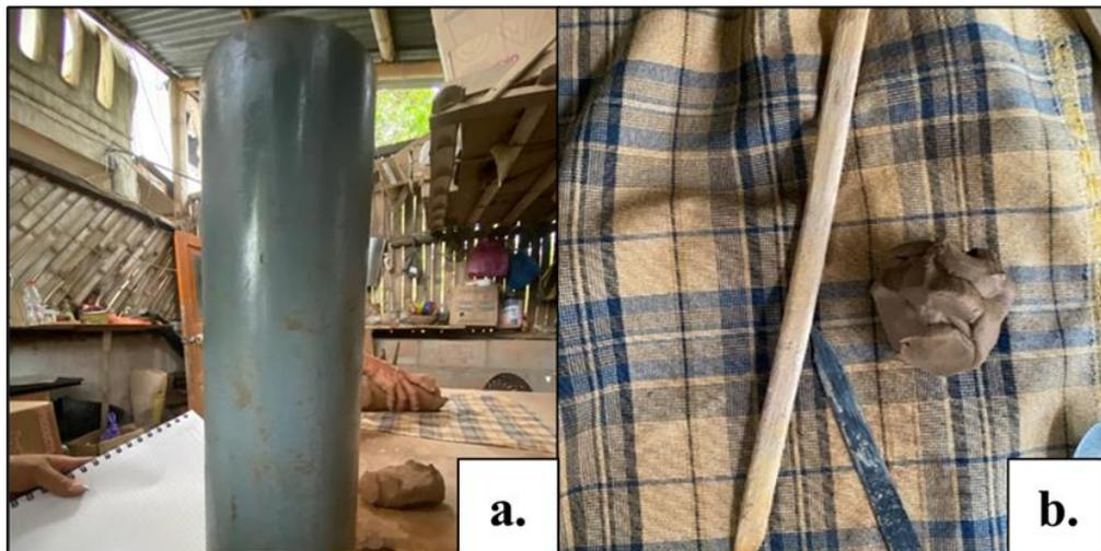
Se debe cerrar de manera manual humedeciendo los bordes y ejerciendo presión dactilar, con la punta de una varita de caña guadua se realiza un canal en el medio del tubo, detallado en la **Figura 10**, este proceso es para compactar bien la masa en la unión, se vuelve a humedecer y se lo rellena nuevamente con la masa sobrante.
