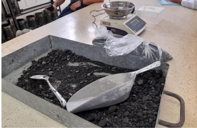
*Nota:* la figura muestra el material asfáltico reutilizado para la nueva mezcla asfáltica
