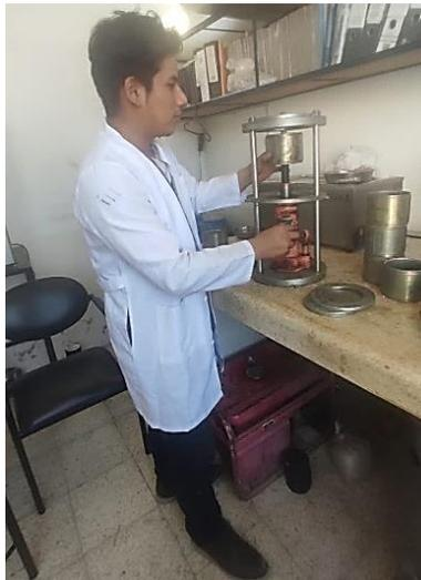
*Nota:* la figura muestra el proceso de desencofrado de las briquetas de la nueva mezcla asfáltica.
