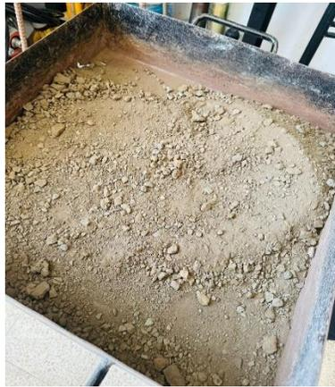
*Nota:* la figura muestra el material reciclado destinado a la elaboración de briquetas y ensayo volumen de vacíos (rice).
