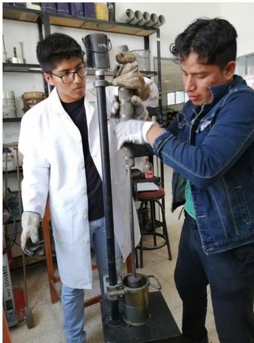
*Nota:* la figura muestra el proceso de compactación de las briquetas.
