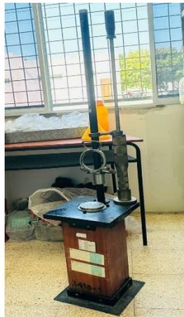
*Nota:* la figura muestra la preparación del martillo Marshall, donde se compactarán las briquetas.
