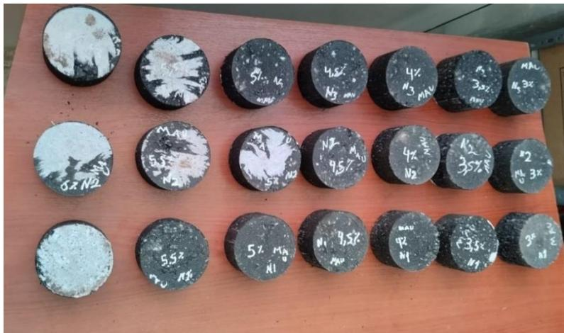
*Nota:* la figura muestra las 21 briquetas, tres por cada contenido de asfalto.
