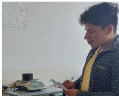
*Nota:* la figura muestra el peso de las briquetas en estado natural, que se utiliza para determinar el peso en el aire.
