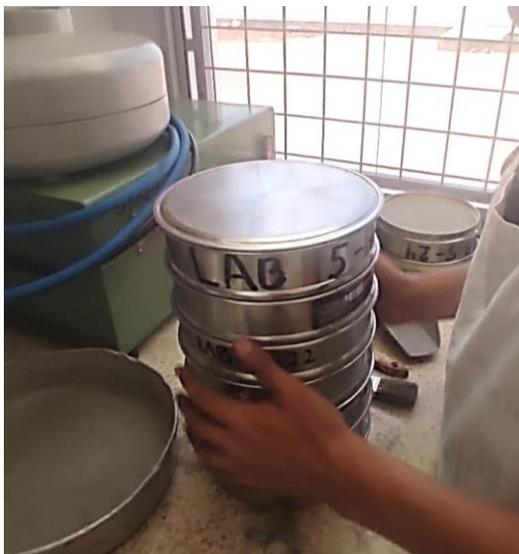
*Nota:* la figura muestra el proceso de tamizado manual
