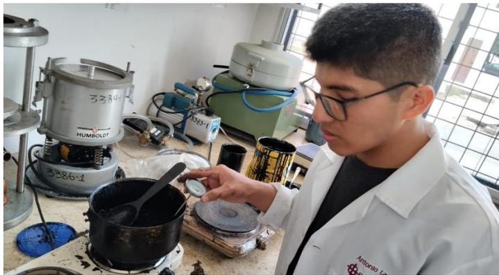
*Nota:* la figura muestra la preparación de la nueva mezcla asfáltica mediante el Método Marshall para ser compactada.
