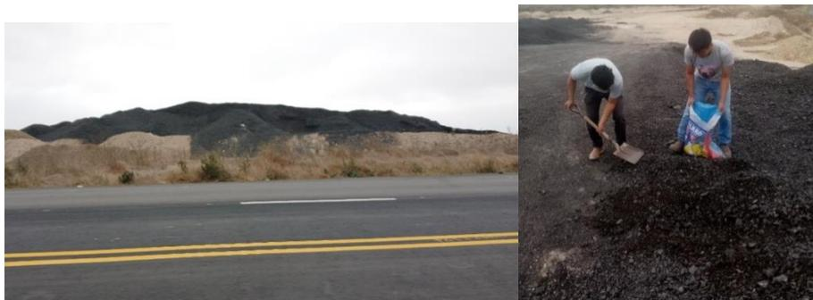
*Nota:* La figura muestra se observa el botadero provisional de donde fue obtenido el material asfáltico reciclado (fresado).
