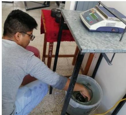
*Nota:* la figura muestra el sumergido de las briquetas para las determinaciones del peso superficialmente seco sumergido.
