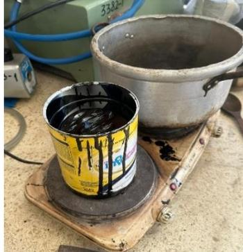
*Nota:* la figura muestra el proceso de calentamiento del asfalto para poner manipularlo en su estado líquido.
