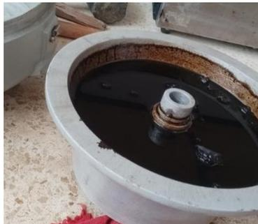
*Nota:* en la figura se muestra la colocación de 500ml de gasolina (solvente) para sumergir el material fresado.
