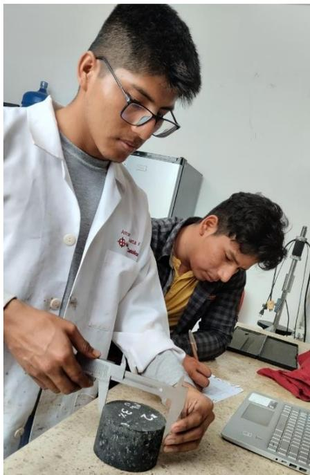
*Nota:* la figura muestra el proceso de medición y registro de las alturas y diámetros de las briquetas con ayuda del calibrador vernier.
