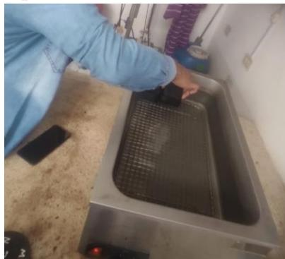
*Nota:* la figura muestra la colocación de las briquetas en el contenedor baño maría.
