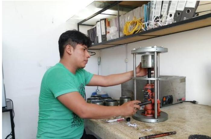
*Nota:* en la figura se observa el proceso de desencofrado de briquetas.
