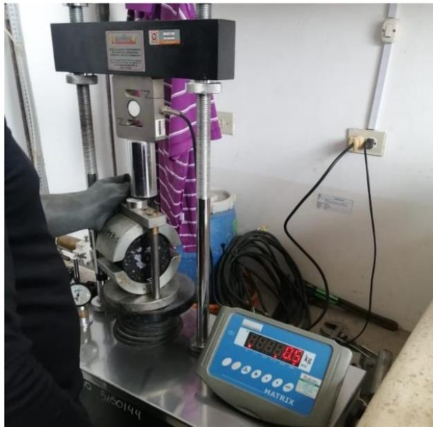
*Nota:* la figura muestra la prensa pinzuar preparada para el proceso de rotura.
