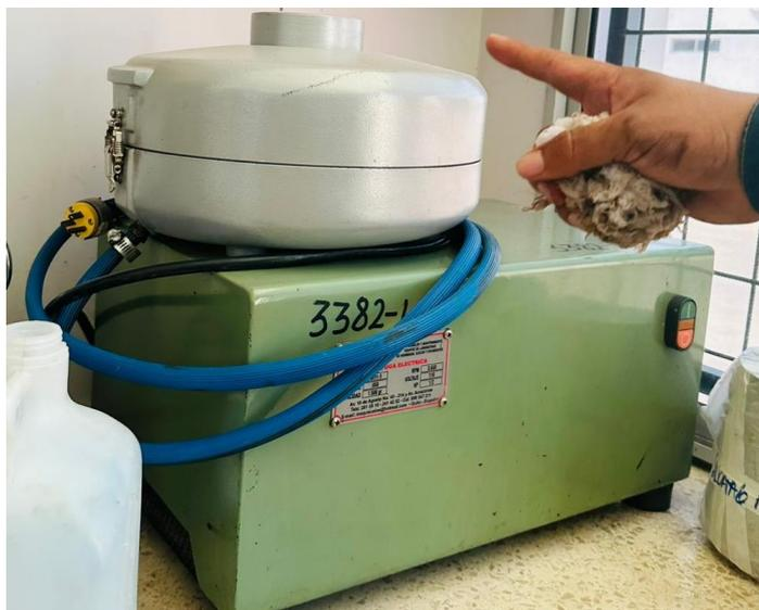
*Nota:* en la figura se muestra la centrífuga eléctrica utilizada para el proceso de extracción de cemento asfáltico del material asfáltico reciclado.
