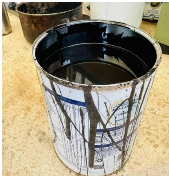
*Nota:* En la figura se observa el cemento asfáltico AC 30 originario de la ciudad de Esmeraldas, proporcionado por la empresa CM Construcciones S.A.
