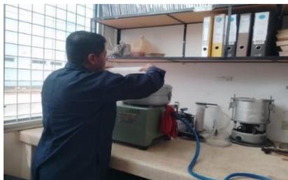
*Nota:* en la figura se muestra la incorporación de 500ml de gasolina (solvente) aplicado consecutivamente, como parte del proceso de lavado del material asfáltico reciclado.
