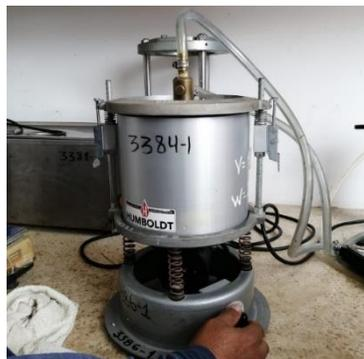
*Nota:* la figura muestra la preparación del equipo para la ejecución del ensayo rice.
