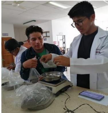
*Nota:* la figura muestra el pesado de los agregados destinados a la elaboración de la mezcla asfáltica en caliente.
