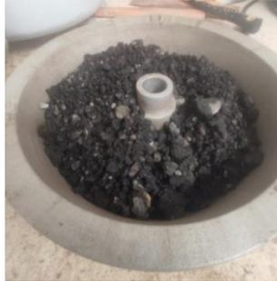
*Nota:* en la figura se muestra la colocación de los 1500 g de muestra de asfalto fresado en el plato de la centrífuga eléctrica.
