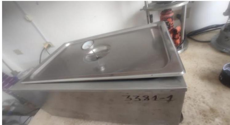
*Nota:* la figura muestra el contenedor baño maría regulado a una temperatura de 60 °C.
