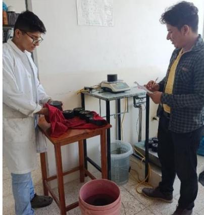
*Nota:* la figura muestra el proceso de secado de las briquetas para las determinaciones del peso superficialmente seco.
