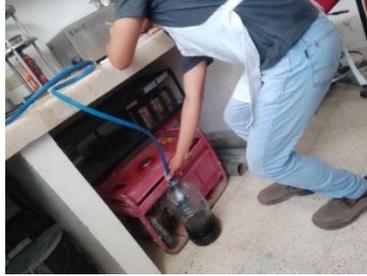
*Nota:* en la figura se representa el proceso de expulsión de asfalto y solvente (gasolina) a través del orificio de desagüe.
