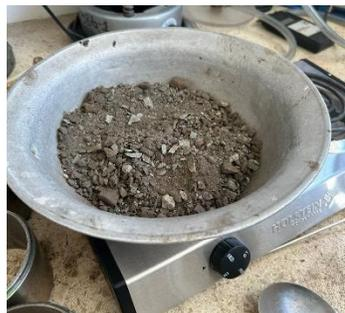
*Nota:* la figura muestra el calentado de los agregados antes de ser mezclados con el asfalto.
