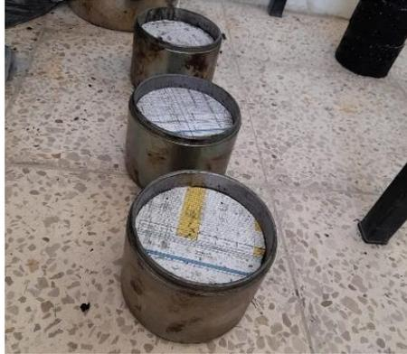
*Nota:* la figura muestra las tres briquetas compactadas de un porcentaje de asfalto del 5,5% de la nueva mezcla ejecutada.
