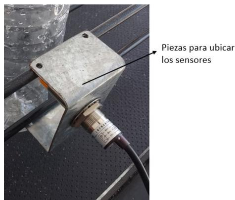
*Figura 94. Sensores capacitivos acoplados en las piezas elaboradas para contenerlos y ubicarlos*
