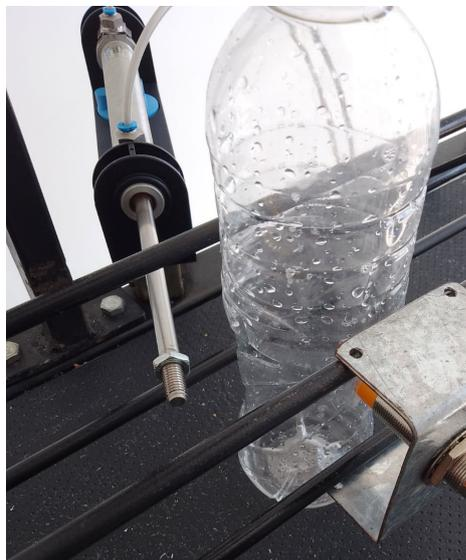
*Figura 115. Vástago de pistón neumático expulsado. En funcionamiento adecuado*
