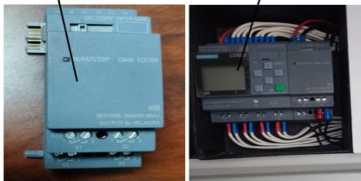
**Figura 97.** Módulo sin adaptar/Módulo ya adaptado al controlador y colocado en la estructura contenedora
