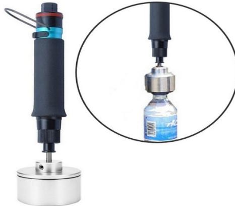
*Figura 42. Acción de tapado y enroscado de tapa en botella a través de una maquina taponadora manual. Fuente: Autoría propia*
