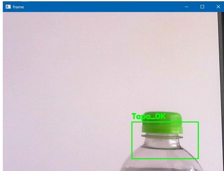
**Figura 118.** Testeo de precisión en la detección de tapas colocadas en botellas con modelo que ha sido entrenado con 400 muestras. Primer testeo: No es muy preciso
