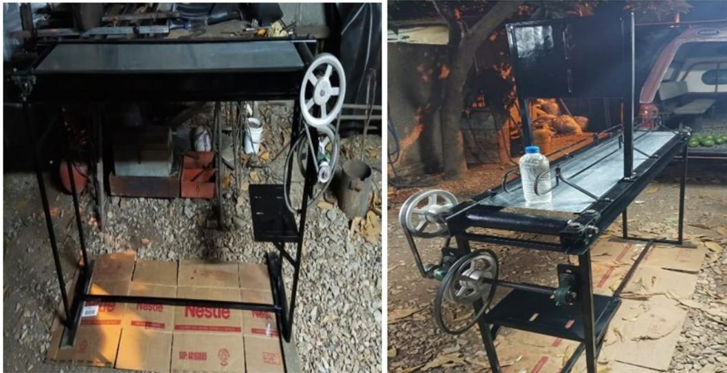
*Figura 92. Banda transportadora en fases finales de construcción*
