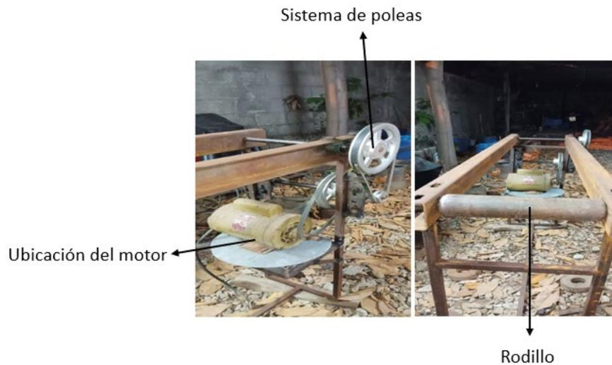
*Figura 91. Fases iniciales de la construcción de la banda transportadora*
