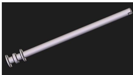
*Figura 90. Vista del modelado 3D del vástago del actuador neumático de doble efecto. Fuente: Autoría propia*
