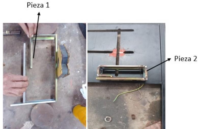
*Figura 93. Elaboración y resultado final de piezas para colocar y posicionar actuadores neumáticos. Pieza 1 para posicionar actuador de doble efecto y Pieza 2 para posicionar actuador de simple efecto.*
