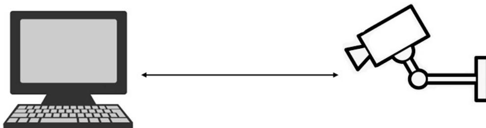
*Figura 13. Esquema de comunicación entre la PC con el algoritmo de visión artificial para inspeccionar la calidad del tapado de las botellas mediante una cámara. Fuente: Autoría propia*
