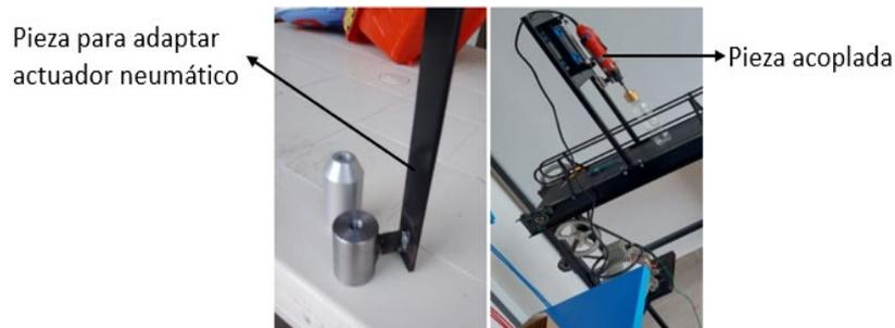
*Figura 95. Pieza elaborada y usada para adaptar actuador y máquina selladora*
