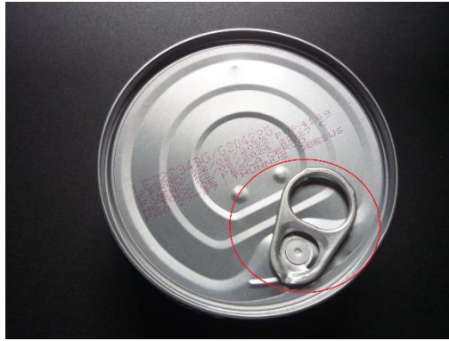
Figura 5: Anilla de Abrefácil mal posicionado
