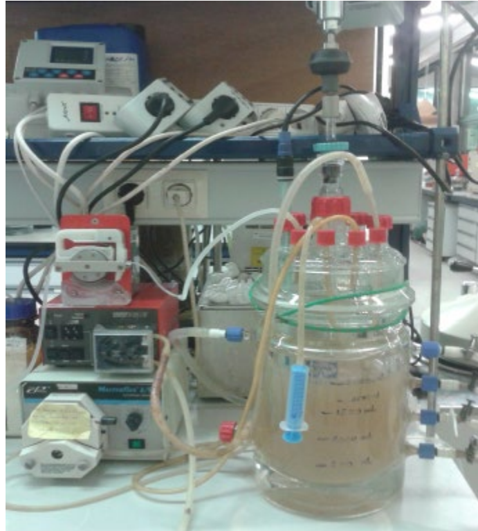
Figura 2.4 Reactor acidogénico en modo secuencial (SBR).
