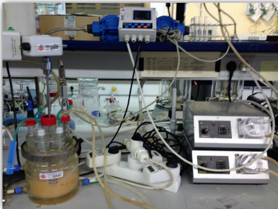
Figura 2.6 Reactor aerobio secuencial empleado en la fase de enriquecimiento de microorganismos acumuladores de PHA.
