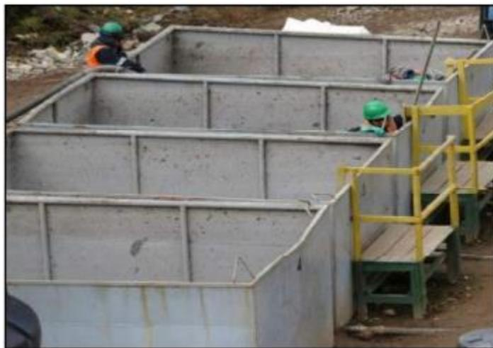
*Figura 6. Tanque de almacenamiento de lodo de perforación (Tenorio, 2015)*
