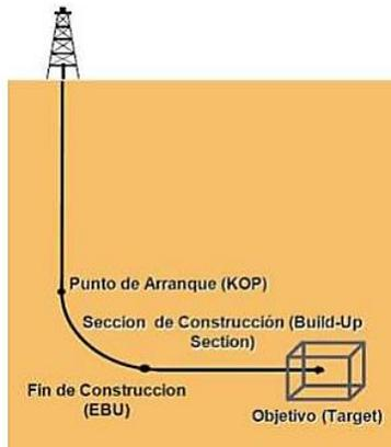
*Figura 3. Ilustración de un pozo horizontal (Guayes I, 2023).*
