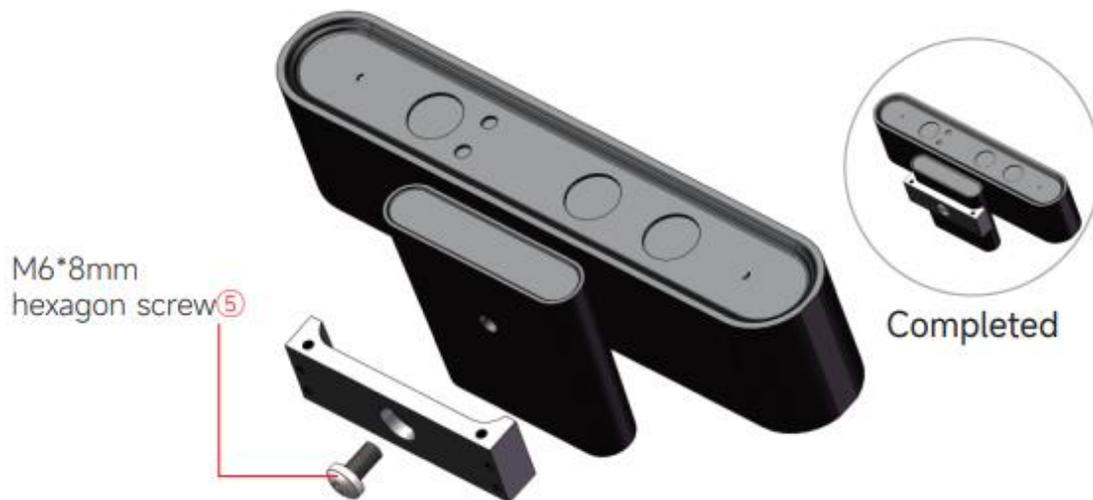
11) Una vez terminada de armar la cámara, se debe voltear la placa para entornillar y postrar la cámara en la placa de la siguiente manera.
