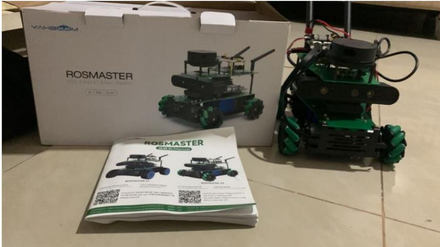
Finalizado el ensamblaje del robot, se procede a encenderlo verificando mediante la app del robot MakerControl (la descripción de la descarga se encuentra en el folleto disponible para IOS y Android). Mediante la app se verificarán cosas básicas tales como la encendida de la barra de luces, verificar que se mueva el robot con las ordenes indicadas, el funcionamiento correcto de LIAR y la cámara Depth.
