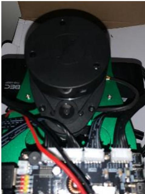
La cámara de nuestro Rosmaster X3 no será problema en instalar debido a que el manual proporciona la información necesaria para la instalación de la misma, una vez montada quedaría de la siguiente manera. En la figura 27 se tiene una imagen de referencia de la cámara Astra Pro montada en el ROSMATER X3 y en la figura 28 una imagen real ensamblada del ROSMASTER X3.
