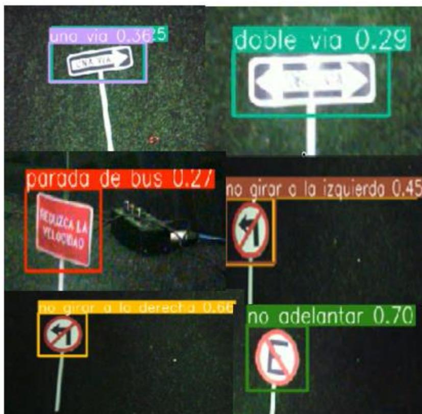
Al analizar las figuras 46 y 47, se puede decir que la Raspberry no es el mejor dispositivo para implementar los modelos de detección basados en Yolo ya que necesita de requerimientos de procesamientos altos, otro dato particular es que las señales de tránsito detectadas deben estar cerca de la cámara del dispositivo, de lo contrario, el modelo empieza a cometer errores en la detección con más confusión en las señales con similitudes explicadas en los resultados anteriores.
