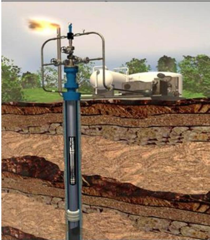
*Figura 20. Bombeo hidráulico y sus componentes en superficie y subsuelo (Sertecpet).*
