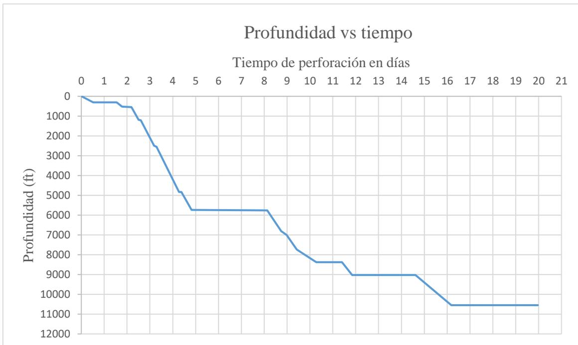
Figura 22. Curva de tiempo de perforación vs tiempo
