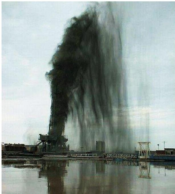
*Figura 6. Arremetida de pozo. Fuente: (Perfoblogger, 2012).*
