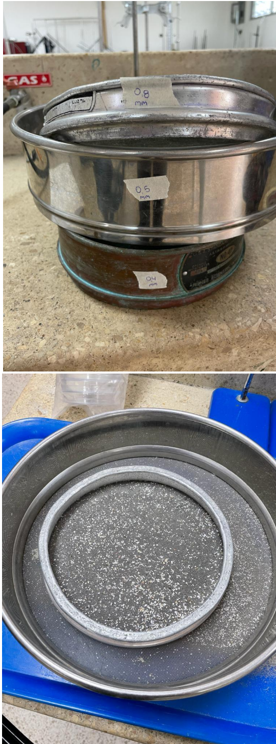
Figura 6. Tamizado para reducción de las muestras con tamices de diferentes medidas, 0.8 mm; 0.5 mm y 0.4 mm
