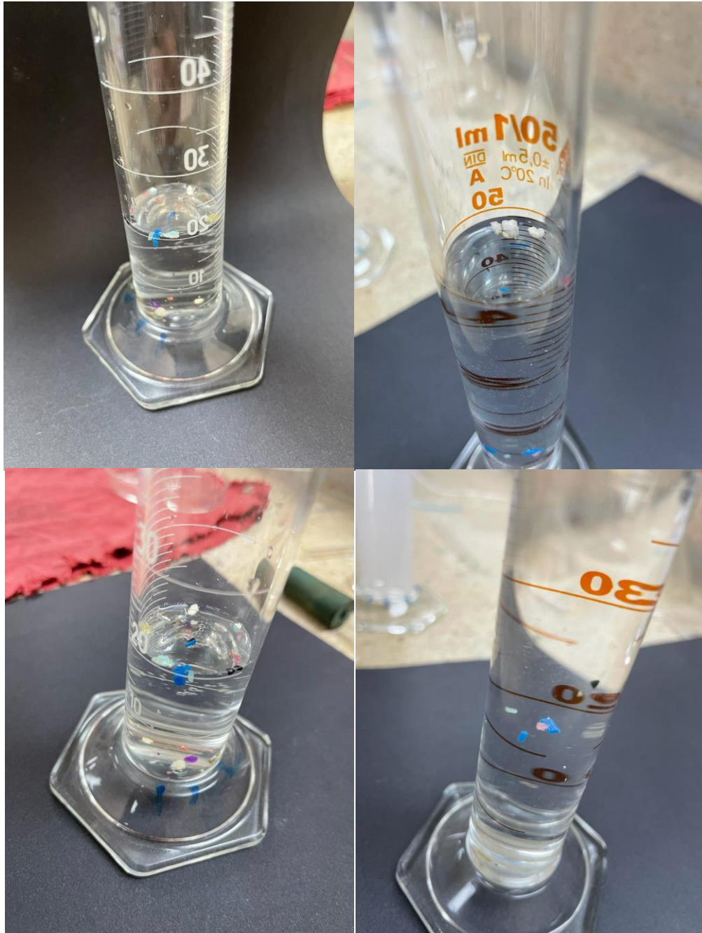
Figura 10. Pruebas con etanol y cloruro de zinc para identificar las densidades y el tipo de polímero de los microplásticos
