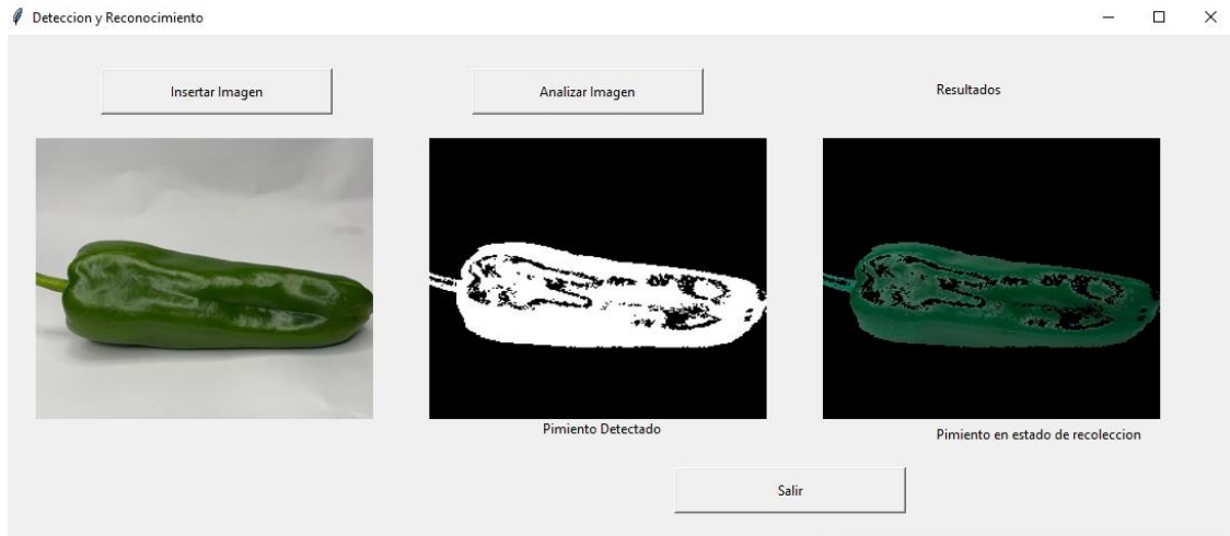
Figura 44: Resultado de Detección de Pimiento: Elaboración Propia.
