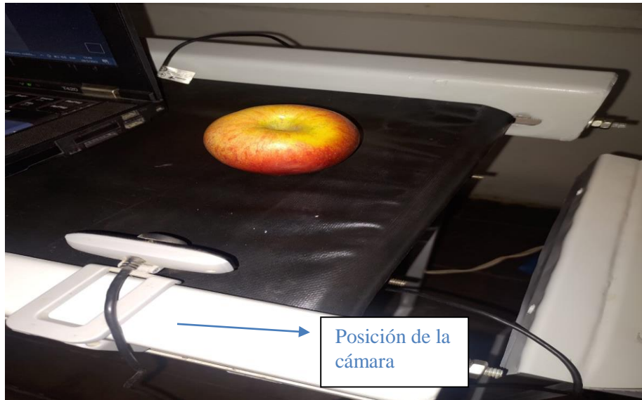
Figura 27. Posición de la cámara para captura de imagen.
