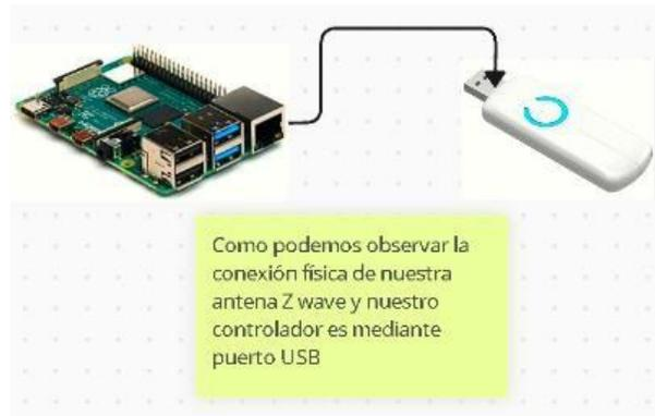
Figure 39: CONEXIÓN FISICA ENTRE ANTENA Z WAVE Y CONTROLADOR
