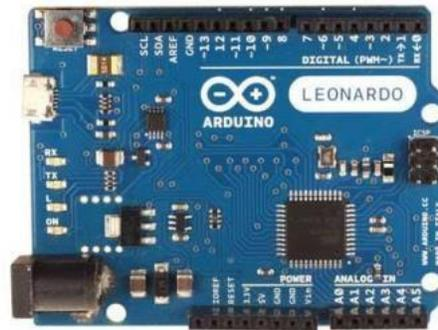
FIGURE 13 IMAGEN DE ARDUINO LEONARDO (ARDUINO, Arduino Leonardo, 2022)
