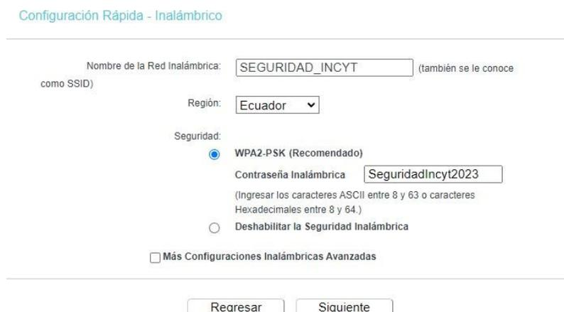
Figure 93 INTERFAZ DEL ROUTER PARA CREACIÓN DE SSID Y CONTRASEÑA PARA LA RED
